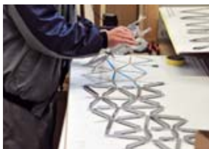
Die Stäbe der Primärstruktur werden vorsortiert
